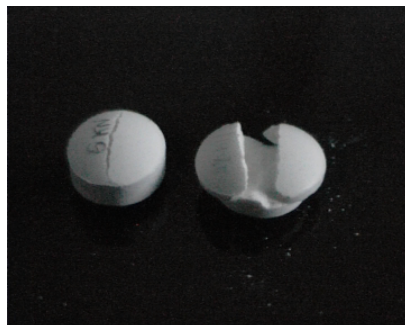
Figure 34 test de rupture diamétrale de compact concave (cellulose microcristalline).
