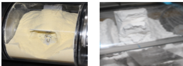
Figure 20 – Visualisation de l'écoulement de poudres sur une pale droite en rotation autour d'un axe horizontal : semoule (gauche) et lactose (droite) agités par une pale non-inclinée
