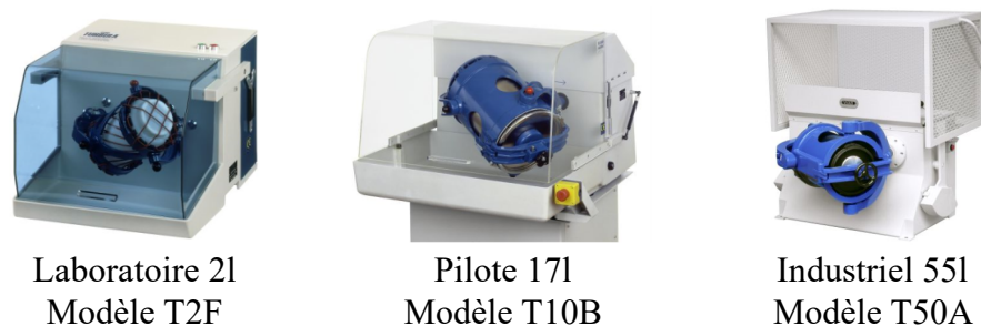
Figure 36 - Modèles de mélangeur Turbula® pour étude du changement d'échelle
