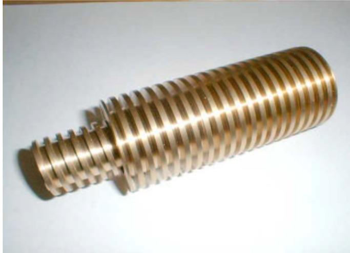
Photographie 2.4. Échangeur thermique
