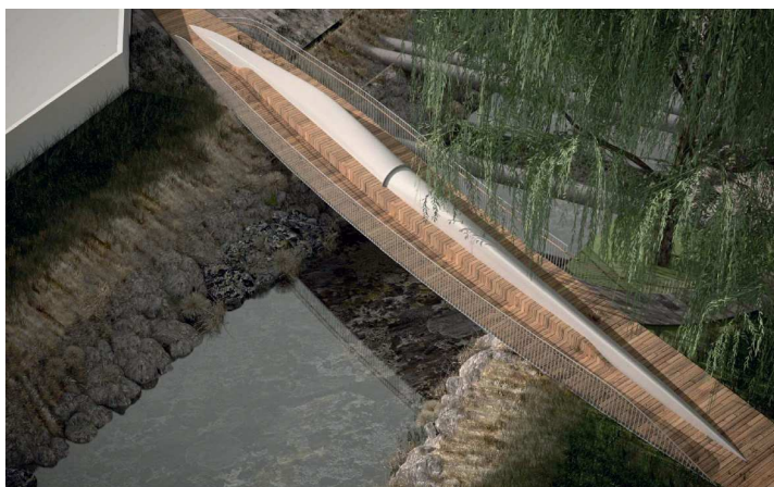
FIGURE 5: PROTOTYPE DE PASSERELLE PIÉTONNE UTILISANT UNE PALE D'ÉOLIENNE DÉCOMMISSIONNÉE POUR STRUCTURE PRIMAIRE, [10]
