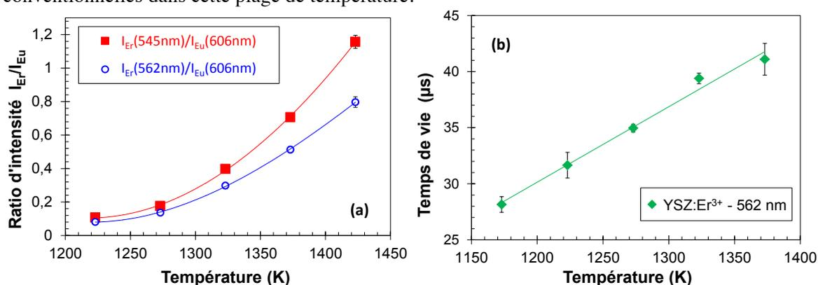
Fig. 1 : Sensibilité à l'histoire thermique du marqueur YSZ:Er<sup>3+</sup>/YSZ:Eu<sup>3+</sup> développé (poudres) : évolution (a) des ratios d'intensité  $I_{Er}/I_{Eu}$  et (b) du temps de vie du pic d'émission à 562 nm des ions Er<sup>3+</sup> avec la température d'exposition pour des traitements thermiques isothermes de 15 min entre 1173K et 1423K.
