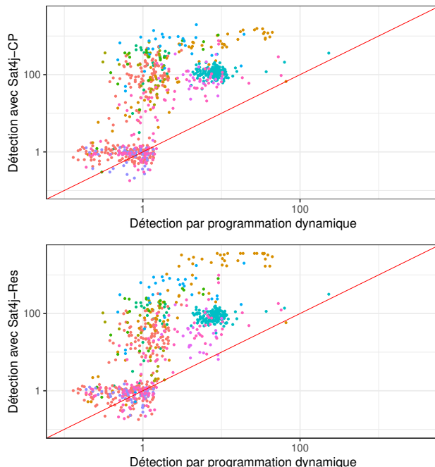
FIGURE 2 – Comparaison des trois approches en termes de temps d'exécution (en échelle logarithmique). L'abscisse mesure le temps de l'approche par programmation dynamique, et l'ordonnée celui des approches utilisant Sat4j : Sat4j-CP (en haut) et Sat4j-Res (en bas). Les couleurs utilisées sont les mêmes qu'à la figure 1.
