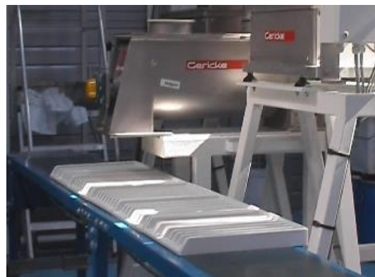
Fig. 1. Two 1D sampling procedures developed at lab-scale for a Turbula® batch mixer and at pilot-scale continuous mixer Gericke GCM500® Рис. 1. Две одномерных процедуры отбора проб для лабораторного смесителя периодического действия Turbula® и для пилотного непрерывного смесителя Gericke GCM500
