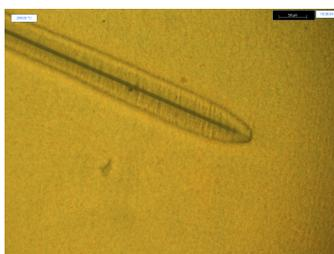
Fig. 2. Transcristallinité observée sous microscope optique munie d'une platine Linkam
